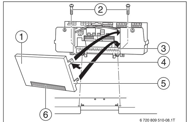
Рис. 22 Крепление Logamatic 4000
