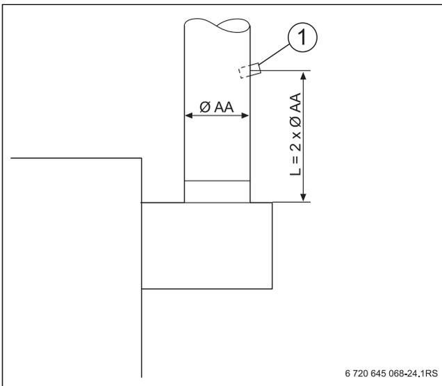
Рис. 35 Точка замера на дымовой трубе
