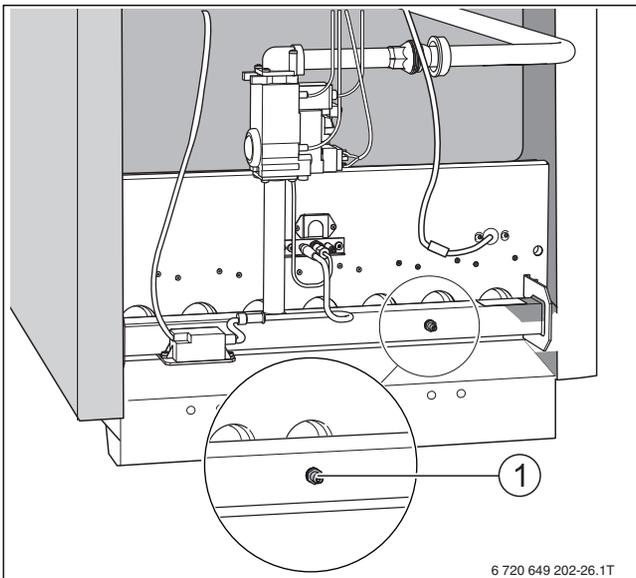
Рис. 30 Проверка форсунок основного газа
