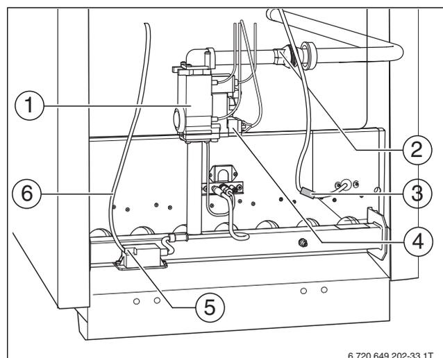
Рис. 47 Демонтаж горелки
