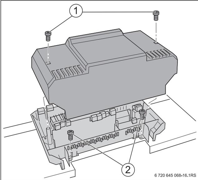
Рис. 16 Снятие верхней крышки
