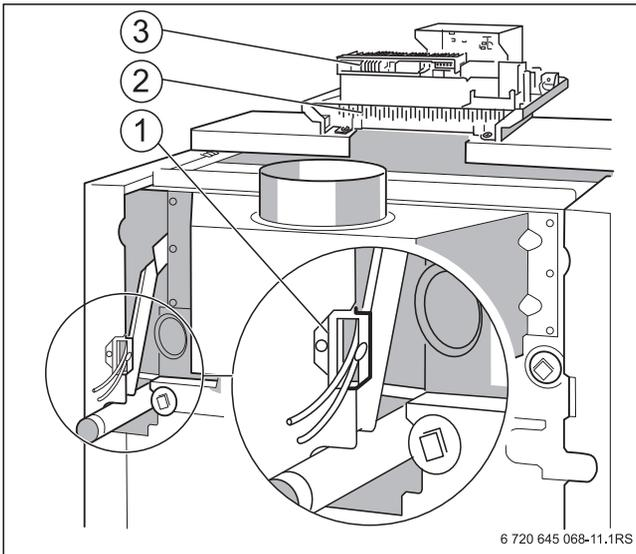
Рис. 23 Подключение электрических проводов
