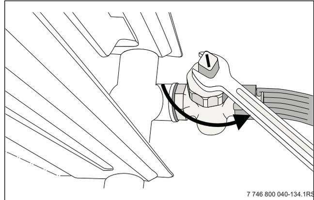
Рис. 43 Слив воды из отопительной системы при опасности заморзания
