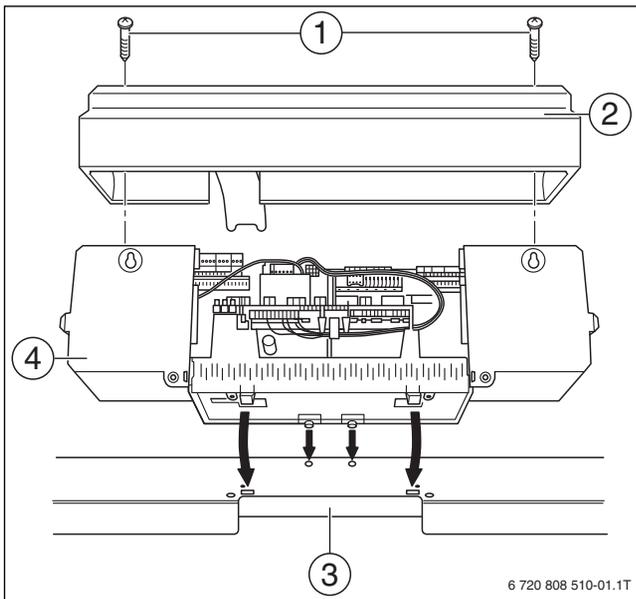
Рис. 20 Открытие и установка системы управления
