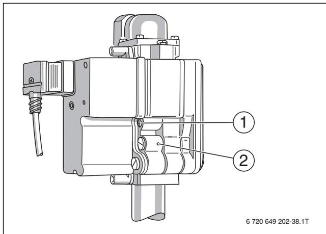
Рис. 56 Газовая арматура "BM" 762-012
