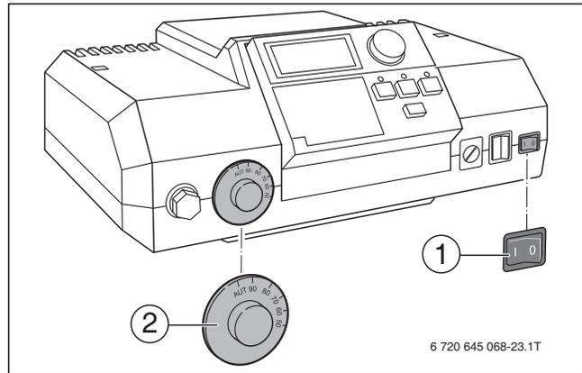
Рис. 31 Включите отопительную установку на системе управления (Logamatic 2000)
