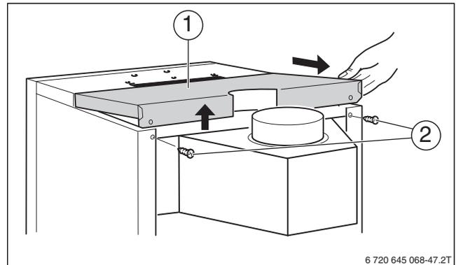
Рис. 14 Снятие задней крышки котла
