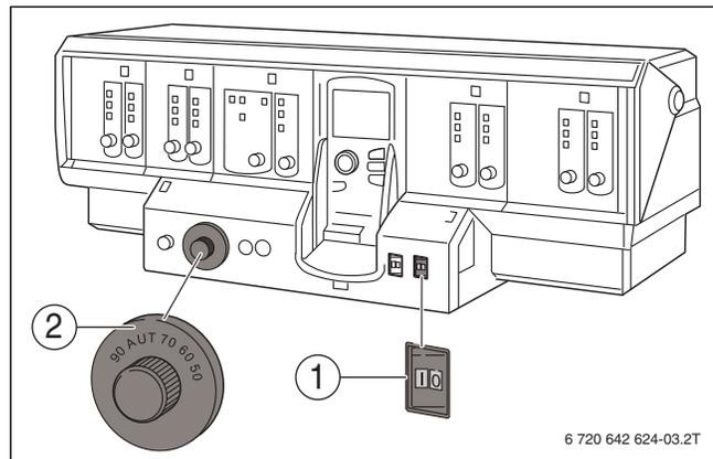
Рис. 32 Включите отопительную установку на системе управления (Logamatic 4000)
