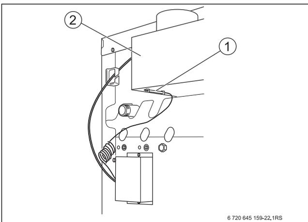
Рис. 40 Проверка устройства контроля дымовых газов AW 50
