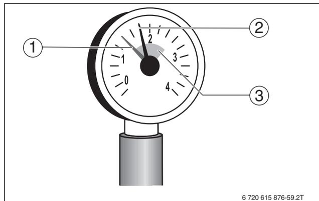
Рис. 47 Манометр для закрытых систем
