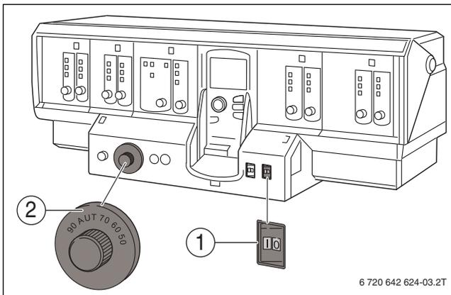
Рис. 34 Включите отопительную установку на системе управления (Logamatic 4000)
