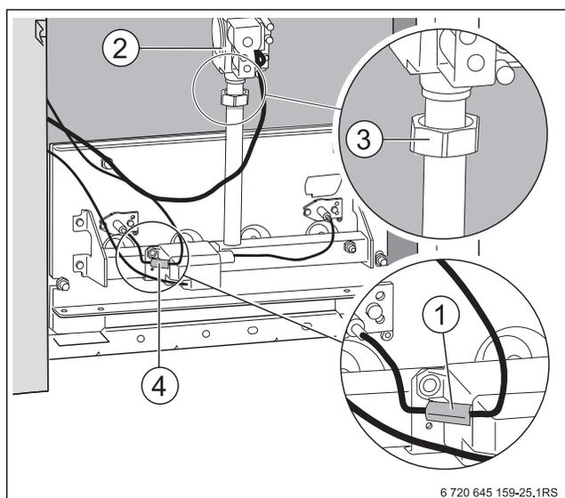
Рис. 49 Демонтаж горелки
