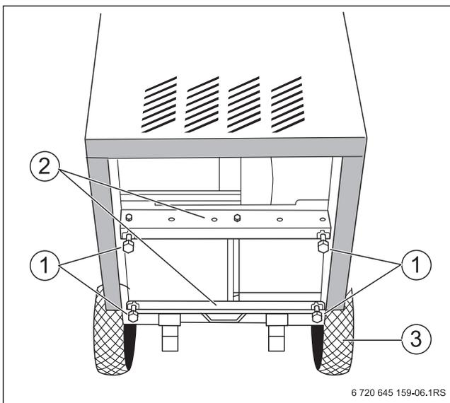
Рис. 8 Установка опорных ножек с помощью тележки
