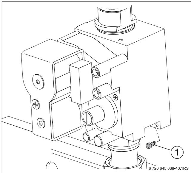
Рис. 57 Установка/удаление переходника для сжиженного газа
