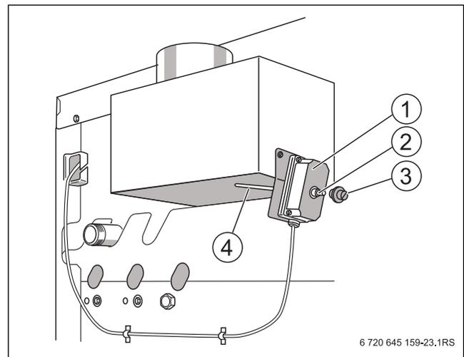
Рис. 41 Проверка устройства контроля дымовых газов AW 10
