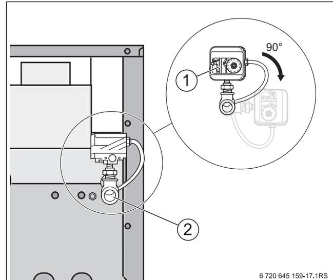
Рис. 10 Подключение газа
