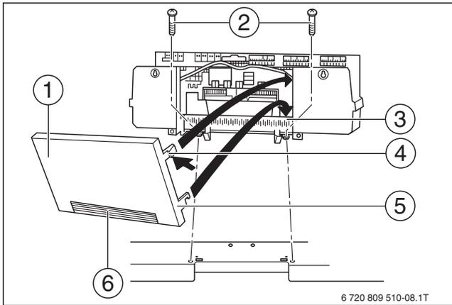
Рис. 25 Крепление Logamatic 4000
