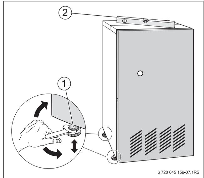
Рис. 9 Выравнивание котла
