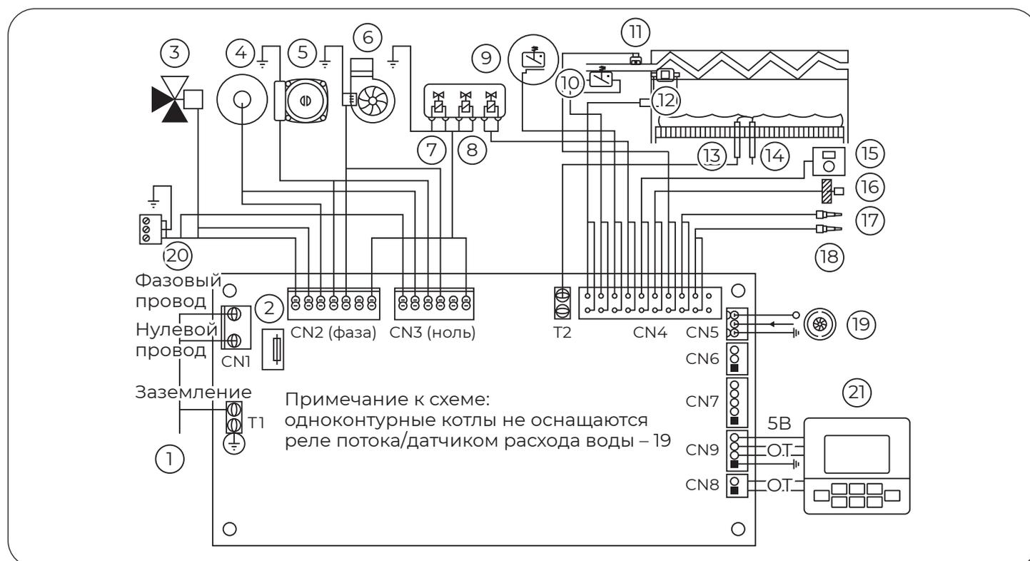
Рис. 31. Электрическая схема.
