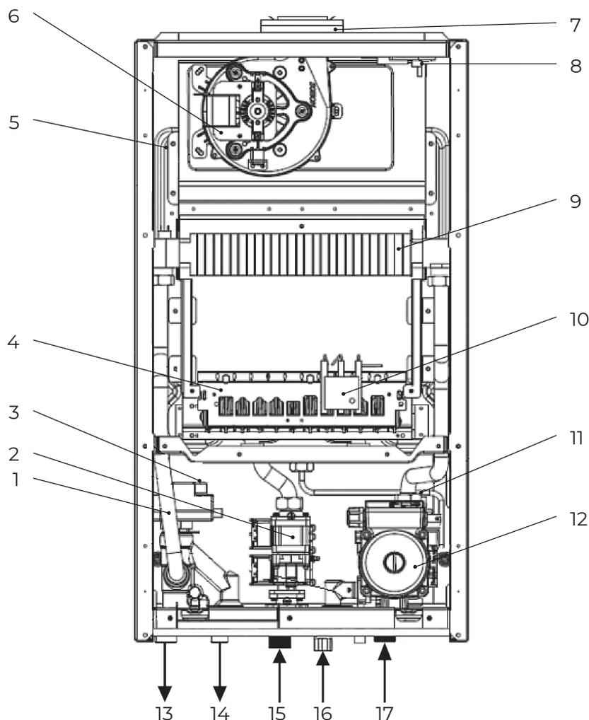
Рис. 5. Общая схема котлов B30 28 H, 32 H, 36 H.
