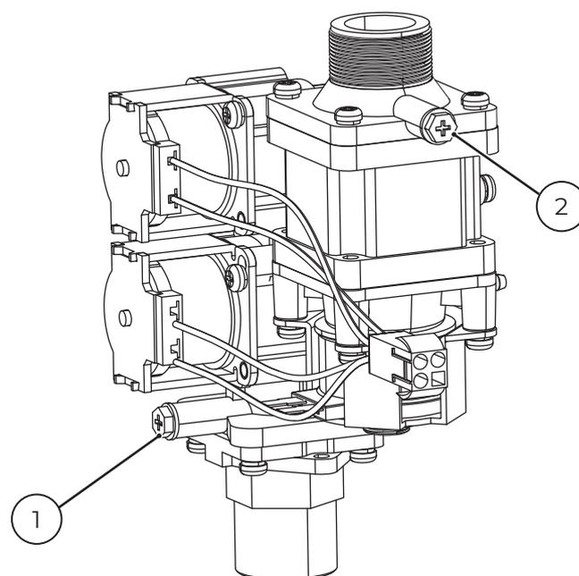
Рис. 25. Газовый клапан.
