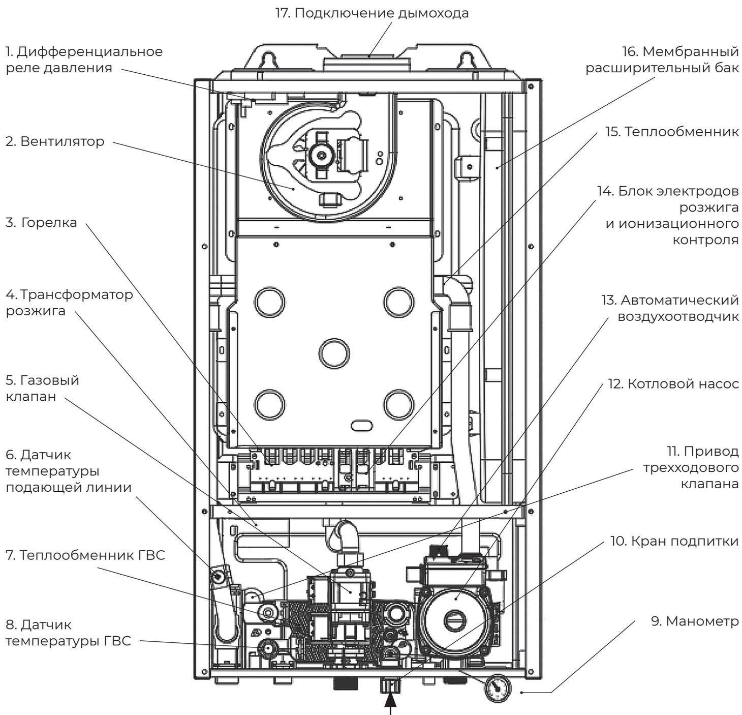
Рис. 2. Общая схема котлов B20 18 С, 24 С.
