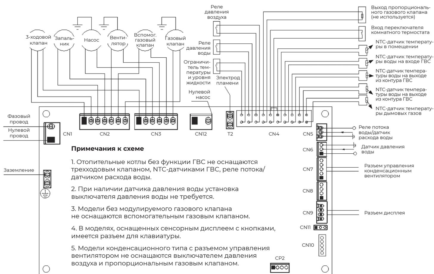
Рис. 25. Электрическая схема.
