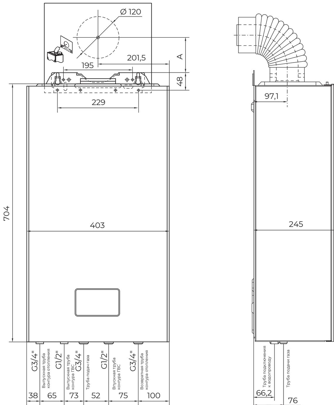
Рис. 22. Монтажные размеры B20 18 C, 24 C.
