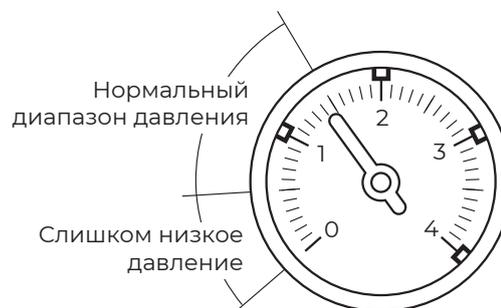
Рис. 5. Показания на манометре.
