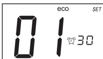
Рис. 16. Настройка времени задержки пуск котла в Эко-режиме.
