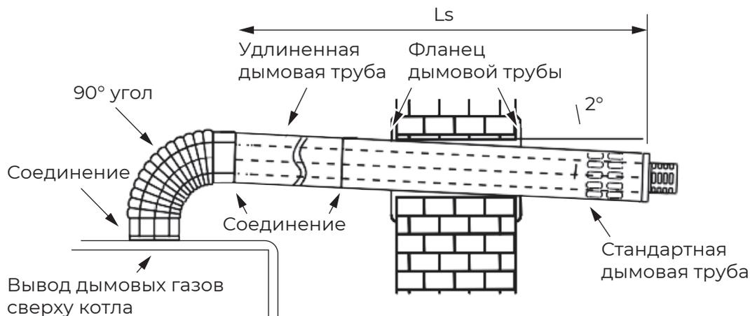
Рис. 24. Пример монтажа схемы С12.
